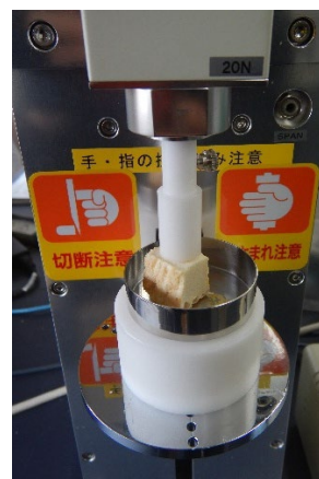
図 3 レオメーターにおけるテクスチャー測定（かたさ荷重の測定）
