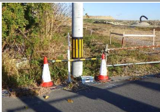
図 3.1.2 騒音測定機器の設置状況の例
