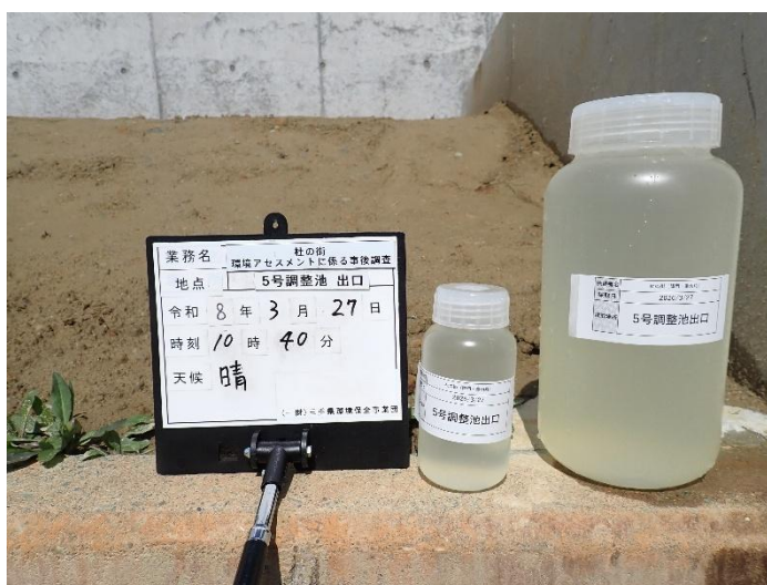
写真 2-1-21 濁水採水状況(No.5) 令和8年3月27日
