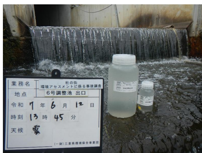
写真 2-1-6 濁水採水状況 (No.6) 令和 7 年 6 月 12 日
