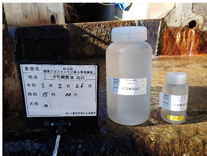
写真 2-1-14 濁水採水状況 (No.6) 令和 8 年 2 月 26 日
