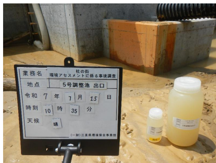
写真 2-1-9 濁水採水状況 (No.5) 令和 7 年 7 月 15 日
