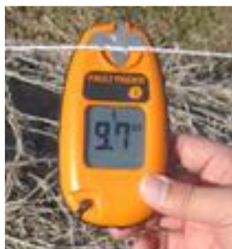
草刈などで漏電を防止し、電圧 5,000 v 以上になるように
