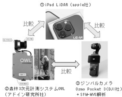
図-6. 地上3次元計測技術による流木量調査の比較検証
