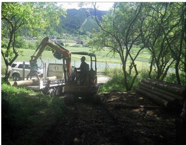
写真5 林地残材の積込状況（山土場）
