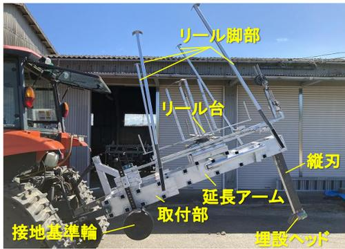
図1 開発した排水管理設装置
