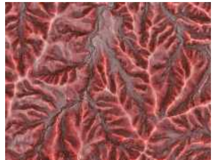
航空レーザ測量結果を用いて作成した 立体地形表現図
