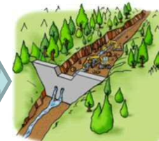
砂防堰堤堆積土砂撤去
