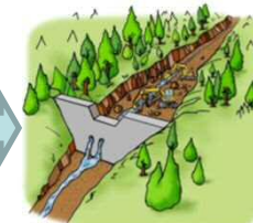
砂防堰堤堆積土砂撤去
