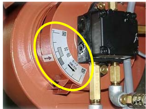
エアシャッターの調整部
