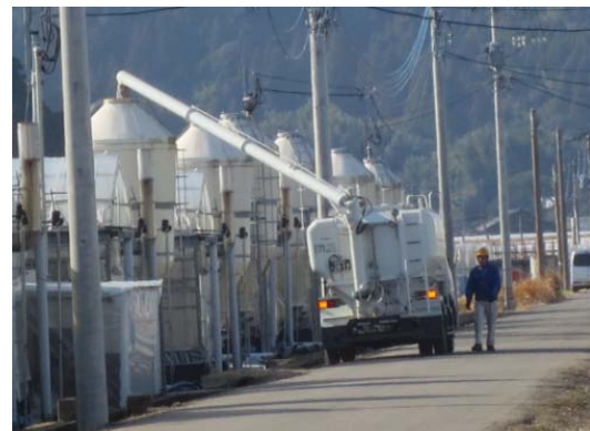
貯蔵タンクへの燃料の投入
