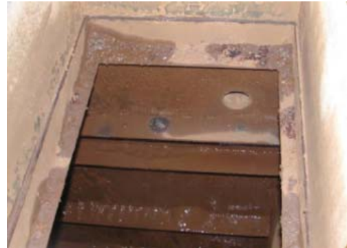
腐食抑制剤を使用していない缶体 (缶体内が腐食し、サビ泥が付着)
