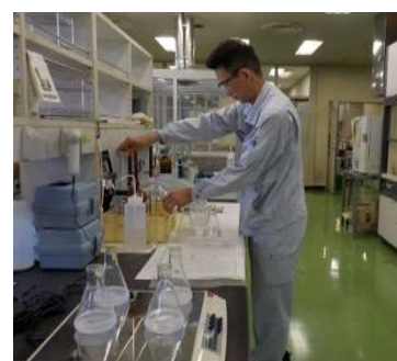
下水処理場での水質検査
