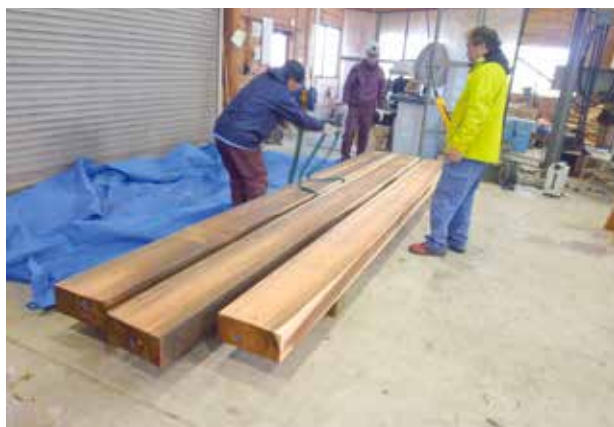
丸太を製材し，梁桁材などの寸法に仕上げます
