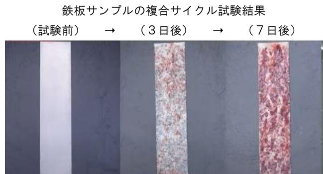
鉄板サンプルの複合サイクル試験結果
