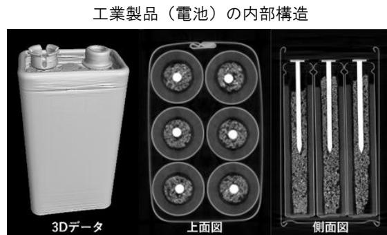
工業製品（電池）の内部構造
