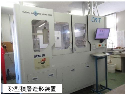
砂型積層造形装置
