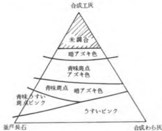
長石（特）を三角座標により調合し、酸化金属Cr<sub>2</sub>O<sub>3</sub> およびSnO<sub>2</sub>を添加し、その呈色を調べた。
