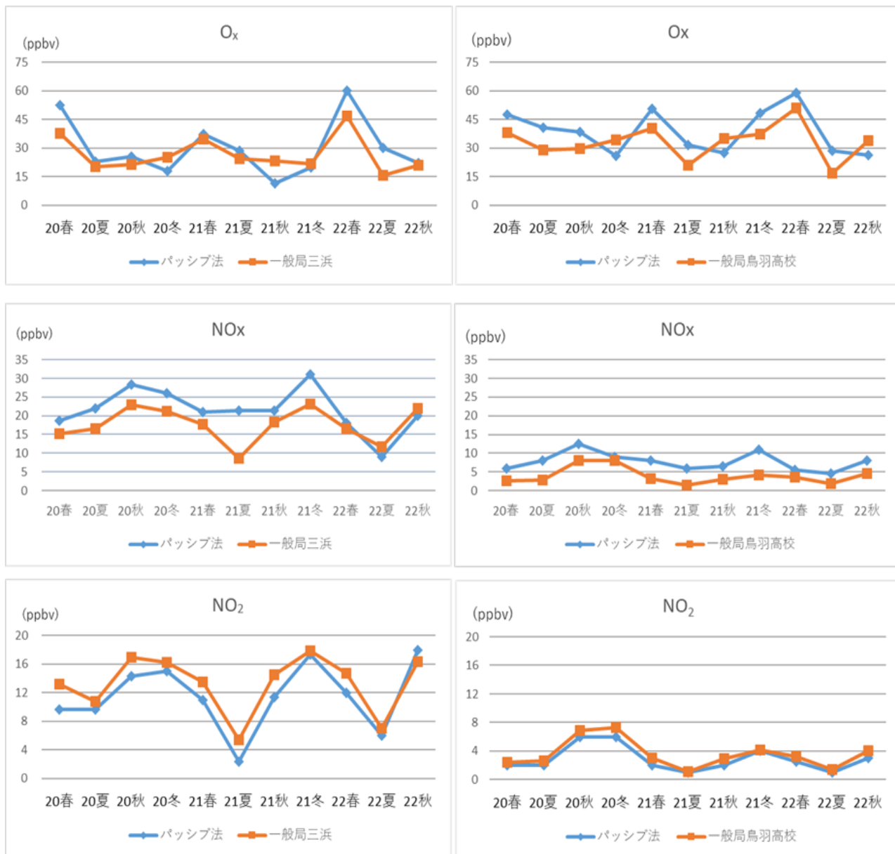
図5 ②三浜および⑦鳥羽高校におけるパッシブ法と測定局データの各成分の濃度変化
