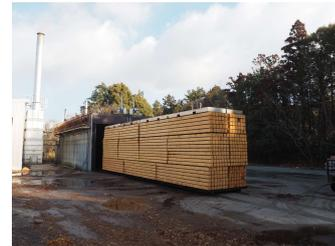
↑寸法を安定させる製材の乾燥工程
