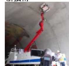
レーザー打音による変状の把握
