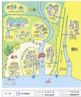
生活排水処理の概念図 資料:生活排水処理施設整備計画(三重県)
