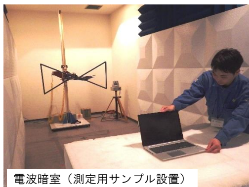
放射ノイズ測定システム（電波暗室内）
