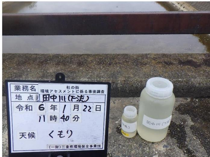
写真 2-1-19 濁水採水状況(田中川 1 : 下流) 令和 6 年 1 月 22 日
