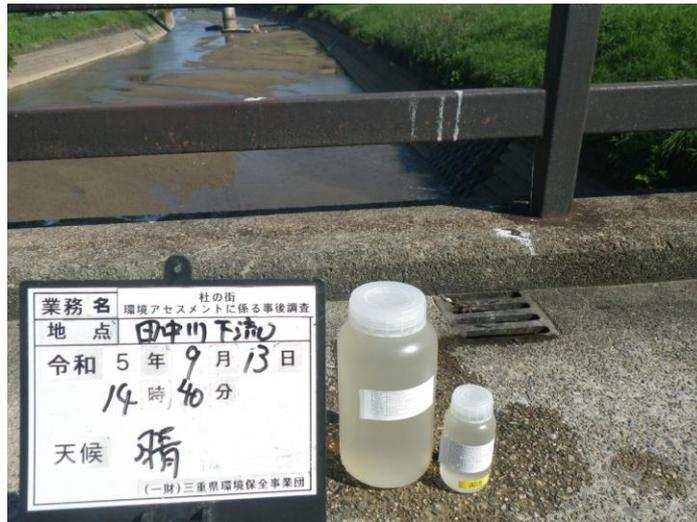
写真 2-1-7 濁水採水状況(田中川1:下流) 令和5年9月13日
