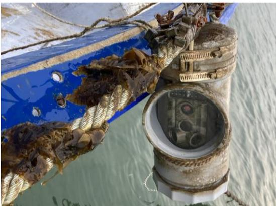
写真3 設置した水中カメラ
