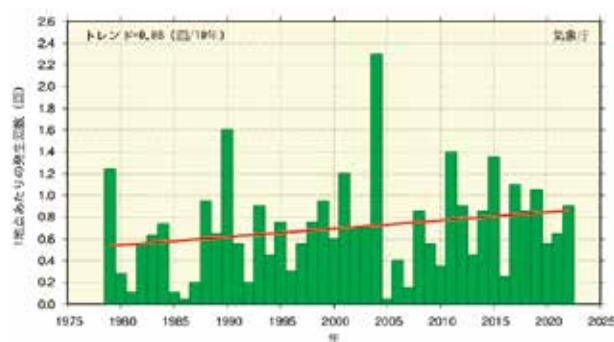
図2.2-9 県内における1時間降水量50mm以上の年間発生回数（1地点あたり）
