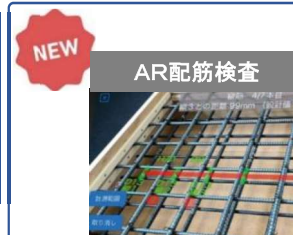
スキャナで鉄筋間隔を自動計測
