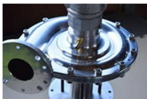
図2 開発したフランシス型水車（水は手前の管から流入し、渦巻き状に羽根に接触した後、下部に流下する。）
