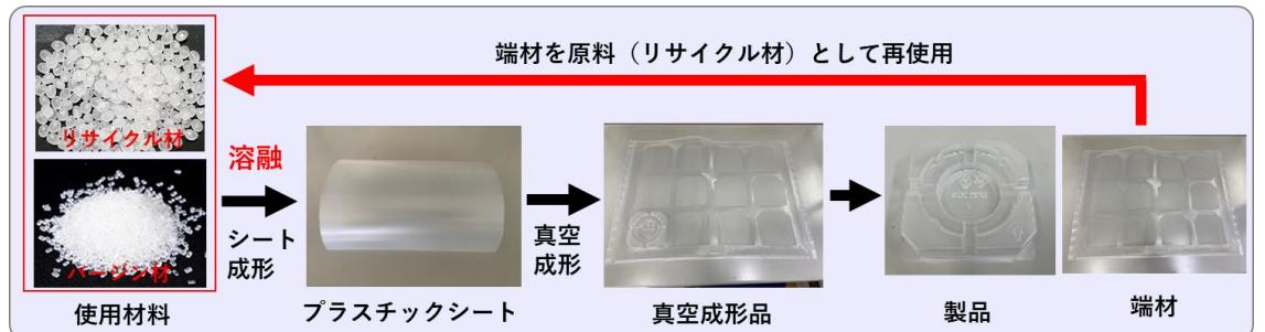
製品端材を再使用した真空成形製品の製造フロー図
