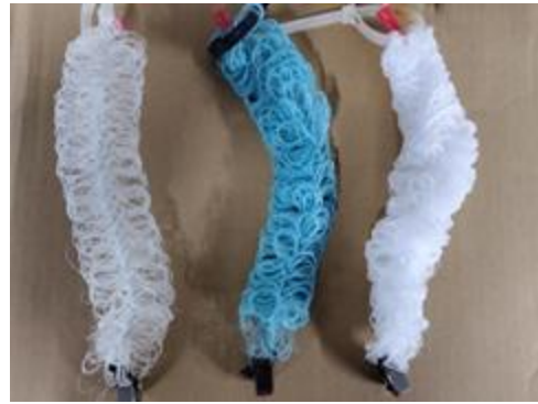
図1. トラップ素材候補（左から，ビニロン，ポリ塩化ビニリデン，ポリプロピレン）
