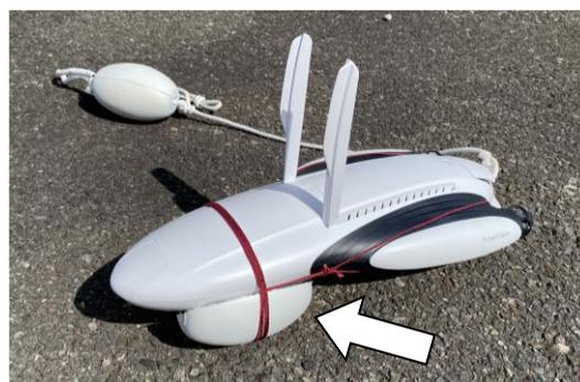
図 2. 船体前方下部に浮子（矢印）を固定した無線操縦ボート
