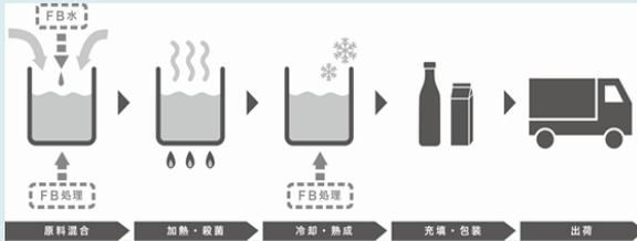
食品・飲料分野でのウルトラファインバブル技術利用の概念図
