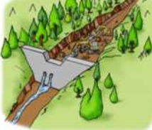
砂防堰堤堆積土砂撤去
