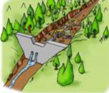
砂防堰堤堆積土砂撤去
