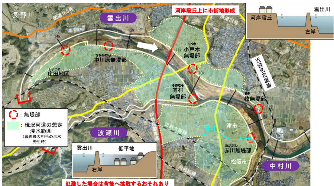
図 13 雲出川 中流部無堤部の概要
