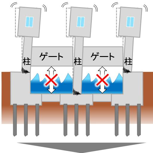
これまでの水門は、供用中に発生する確率の高い地震(L1地震動)をもとに設計されており、南海トラフ地震等の大規模地震が発生した場合、柱等が損傷し、ゲート開閉が出来ない等のリスクがあります。この様な大型水門等が、20施設確認されています。
