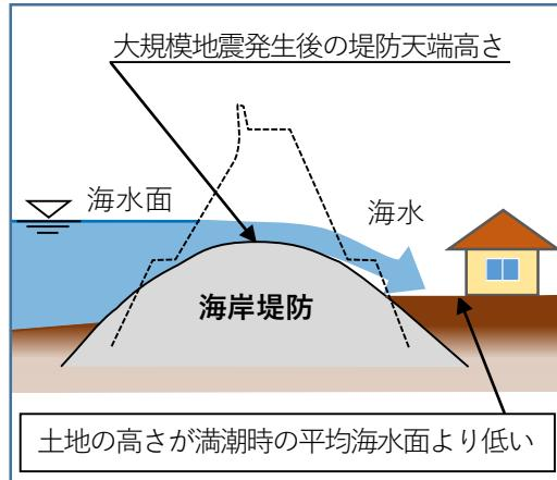
伊勢湾台風等を機に造られた海岸堤防は、大規模地震が発生した場合、沈下や損傷といった変形が生じ、土地の低いゼロメートル地帯では高潮や津波による浸水被害が長期化するリスクがあります。
