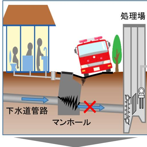
阪神淡路大震災以前の基準で設計された下水道マンホールは、供用中に発生する確率の高い地震(L1地震動)をもとに設計されており、南海トラフ地震等の大規模地震が発生した場合損傷し、下水が流下出来ない事態や道路陥没等が生じるリスクがあります。このようなリスクがあるマンホールが、11基確認されています。
