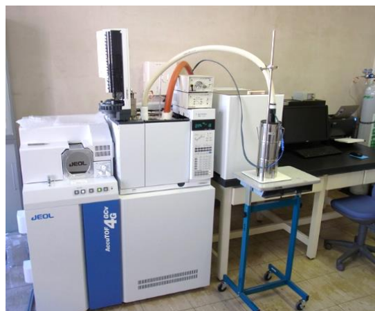
図1 熱抽出装置を備えた GC-MS
