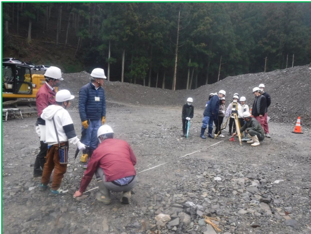
光波測距儀を用いた、距離測定の様子
