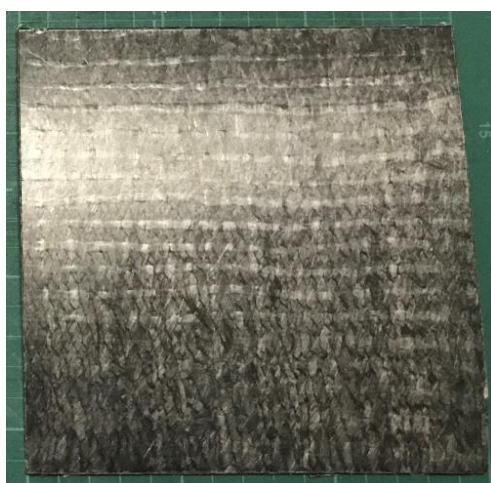
図 11 織物ベースの熱プレス中間基材 (プレス条件: 温度 200°C, 時間 1h, 圧力 150kN)
