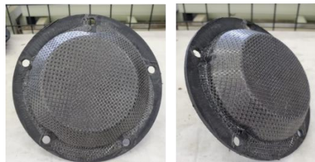
図 16 試験用金型を用いたハイブリッド成形試作品
