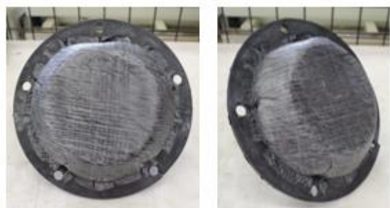
図 14 試験用金型を用いたハイブリッド成形試作品
