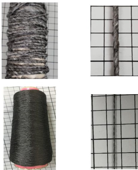
図7 リサイクル炭素繊維とPP繊維からなる 試作紡績糸の外観 (上段:試作紡績糸, 下段:(参考)市販 vCF 紡績糸)
