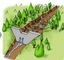
砂防堰堤堆積土砂撤去
