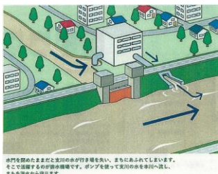
大雨を降ったままだと家田の水が引ききれない、まちにあふれてしまいます。そこで設置するのが排水機場です。ポンプを使って河川の水を吸引し、まちを排水から守ります。
