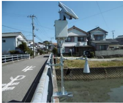
危機管理型水位計 （三重県）
