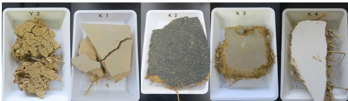
図1 調査を行った土壁材(左から屋根材、聚楽壁、繊維壁、大津壁、漆喰壁)
