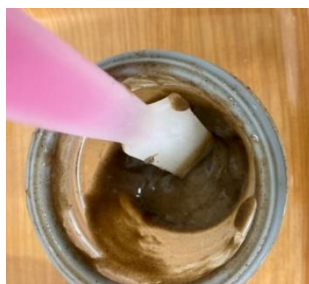
⑥物性の確認をする ※硬いようであれば加水して搅拌する ※軟らかいようであればミキサーゲルを少量入れ搅拌する
