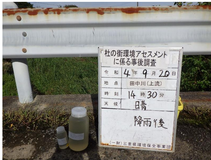
写真 2-1-16 濁水採水状況(田中川 2 : 上流) 令和 4 年 9 月 20 日
