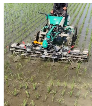
除草機による除草作業の様子
