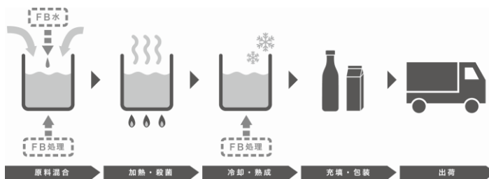
食品製造におけるFB技術利用概念図 (マイクロバブル・ナノバブルの技術と市場 2021)
