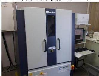
結晶ピーク (Sc) と、非晶ハロー (Sh) の面積比から結晶化度を算出
