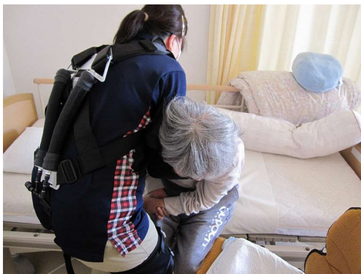
移乗介助用の介護ロボット（パワーアシストスーツ）
