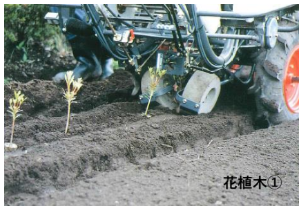
三重サツキのセル成型苗と定植機
