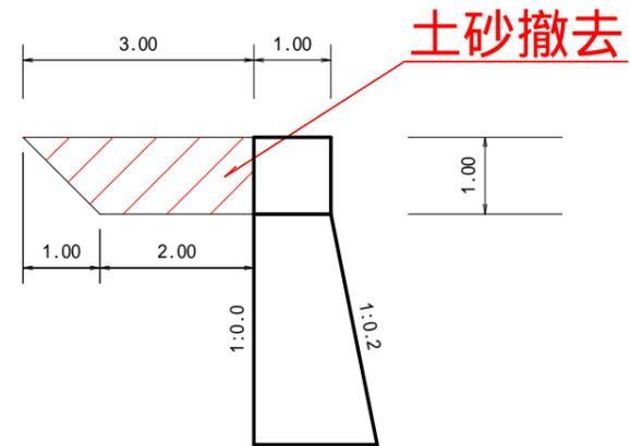
撤去土砂検収図 (1:100)
