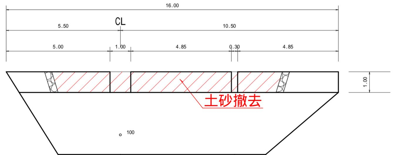
土砂撤去工断面図 S=1:100
