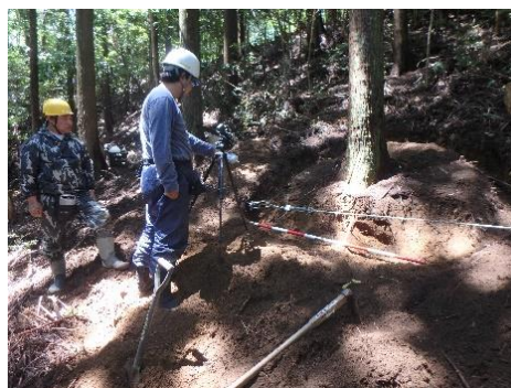
災害に強い森林の育成技術の確立を目的とした、樹木根系の崩壊抵抗力などの調査
