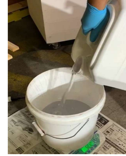
【エポキシ樹脂(レジン)とは】 簡単にいうと接着剤的なプラスチックである。 エポキシ樹脂には石油系と植物性のものがあり、 弊社では環境にやさしい植物性(大豆からつくられた) のものを使用しています。
