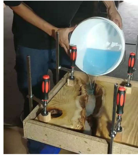
対象の木材を固定してエポキシ樹脂(レジン)を 流し込みし、硬化させる。
