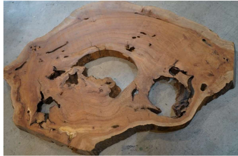
三重県亀山市内産材の欅(けやき)の一枚板 加工前の原板 腐りや虫食いの穴が多く、商品としての価値が低い。
