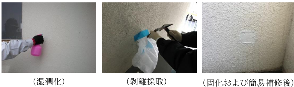
図 I - 5 - 9 サンプルング例 (建築用仕上塗材等)
