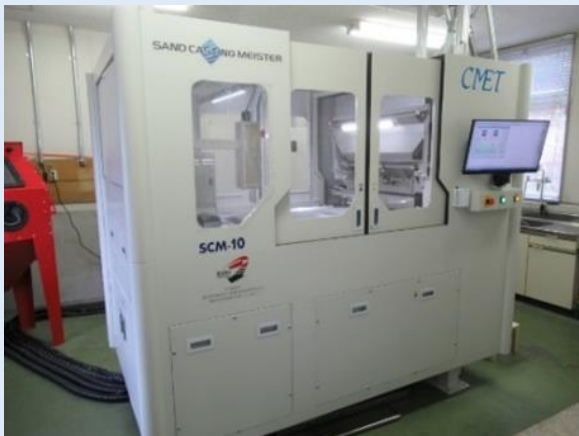
図1 砂型積層造形装置 (SCM-10, CMET Inc.)
