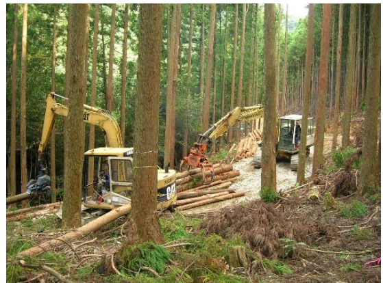
＜高性能林業機械の連携作業＞
